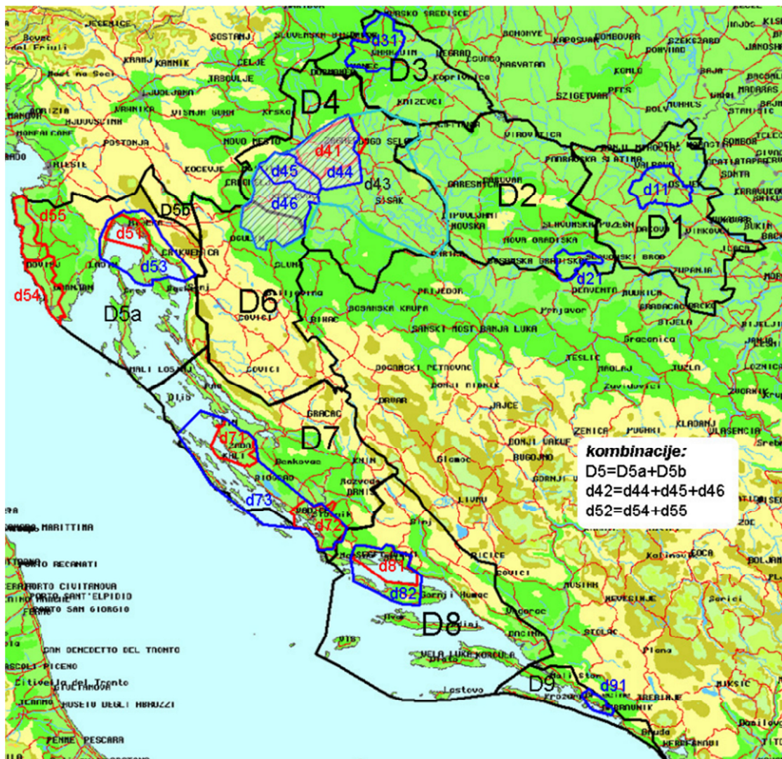
Slika 3.3. Podjela Republike Hrvatske na digitalne regije za zemaljsku radiodifuziju digitalnog televizijskog signala u UHF frekvencijskom području
