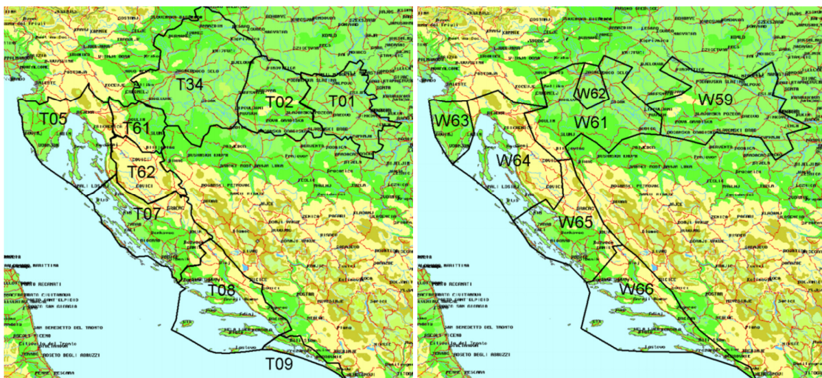
Slika 3.1. Podjela Republike Hrvatske na digitalne regije za zemaljsku radiodifuziju digitalnog radijskog signala u VHF frekvencijskom području
